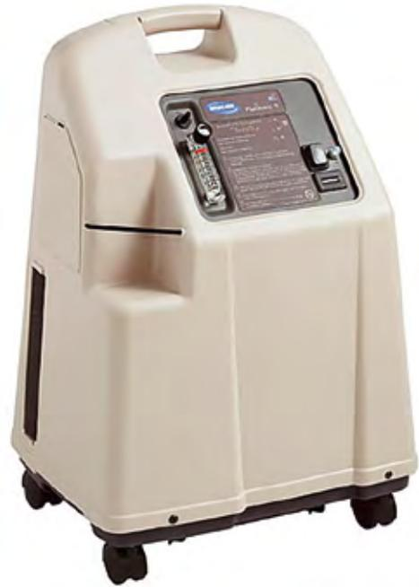
eingesetzt, die regelmäßig auf die Anreicherung der Atemluft mit Sauerstoff angewiesen sind. Ein Sauerstoffkonzentrator saugt Luft zunächst durch ein Filtersystem, um Mikroorganismen und Staub zu entfernen. Die gereinigte Luft wird verdichtet und darin enthaltener Stickstoff durch eine Filtermembran oder ein Molekularsieb abgetrennt. In der Regel wird der Sauerstoff nach dem Verfahren der Druckwechsel-Adsorption angereichert, sein Anteil wird dadurch auf etwa 96% erhöht.
